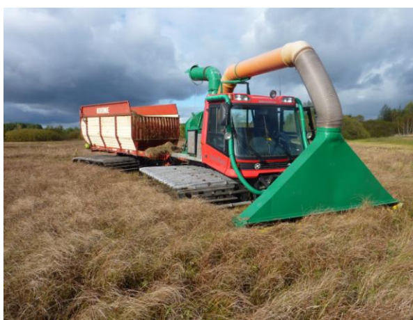
Abb. 2: Links: Einstufiges Ernteverfahren mit direkter Aufnahme der gemähten Biomasse; Rechts: Abtransport von Ballen nach dem Pressen der gemähten Biomasse (Fotos: W. Wichtmann, I. Mirowski).
