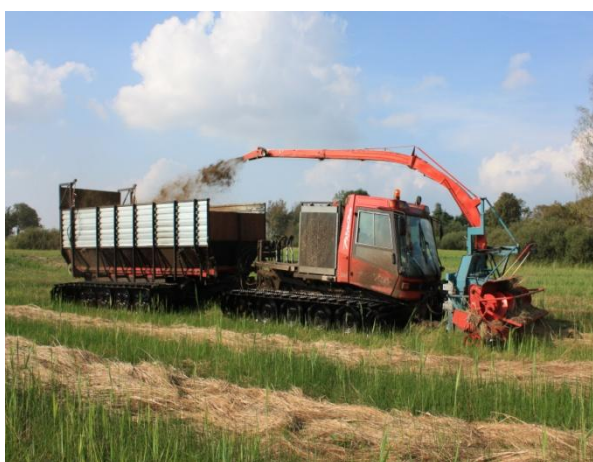
Abb. 1: Links: Beispiel für ein zweistufiges Ernteverfahren mit Raupentechnik: Aufnahme von Schilf nach Ablage im Schwad; Rechts: Konzept für radbasierte Erntetechnik. (Kranemann GmbH)
